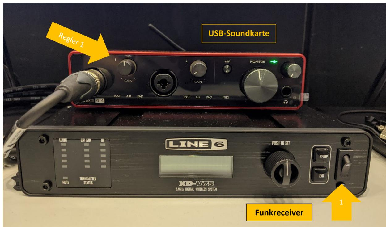
Schalten Sie zunächst den Funkreceiver des Mikrofons ein, indem Sie den Kippschalter ganz rechts am Gerät nach oben legen, sodass das Display aufleuchtet.
