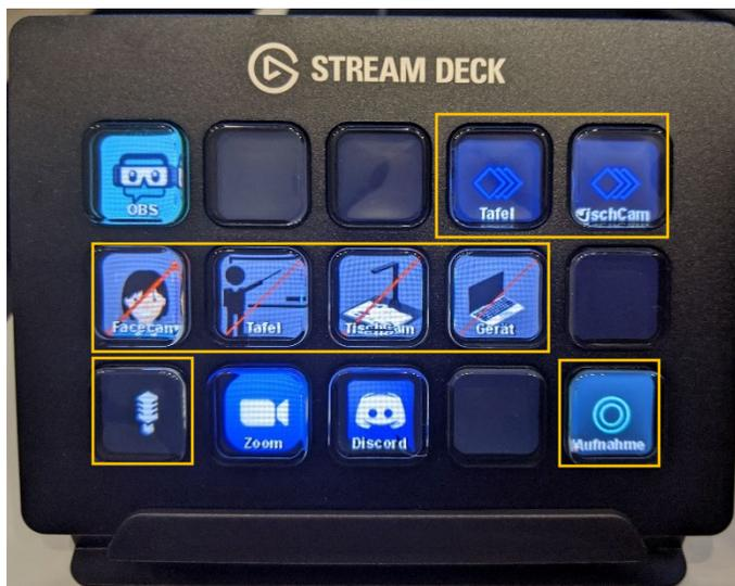
Mithilfe der beiden Tasten oben rechts können Sie durch verschiedene Szenen schalten, um unterschiedlich gezeigte Inhalte der Quellen hervorzuheben. Die Knöpfe in der mittleren Reihe des Stream Decks ermöglichen Ihnen das An- oder Ausschalten einzelner Videoquellen. Mit dem Knopf unten links steuern Sie Ihr Mikrofon und der Knopf unten rechts dient zum Starten und Stoppen von Aufnahmen.
